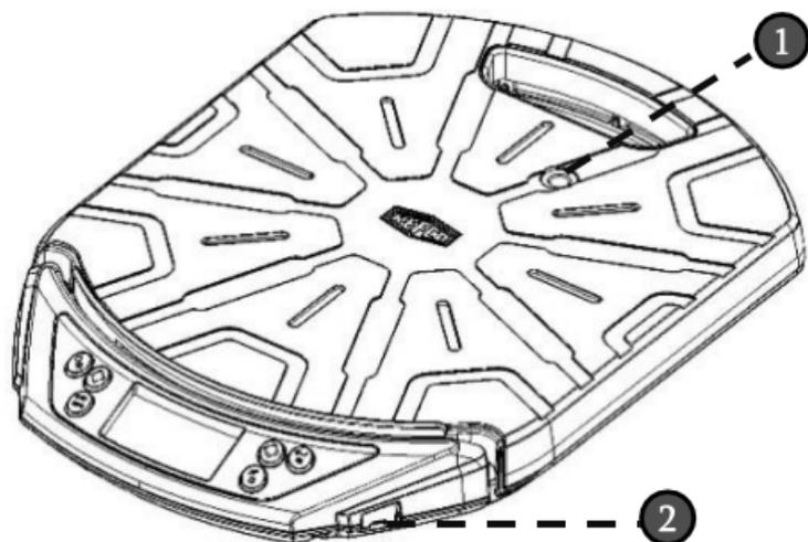
1 M10 Gewinde zum Befestigen des Ventils 10612-REF für Druckdosen.
